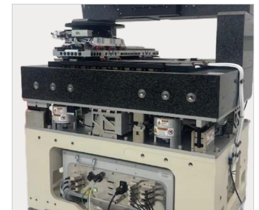
Halbleiterindustrie: komplette Waferplattform, inklusive aktive Schwingungsisolierung und Steuerung
