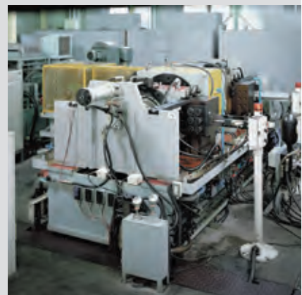
Prüfstand für die Wälzlager von Arbeitswalzen
