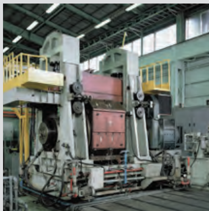
Prüfstand für die Wälzlager von Sützwälzen
