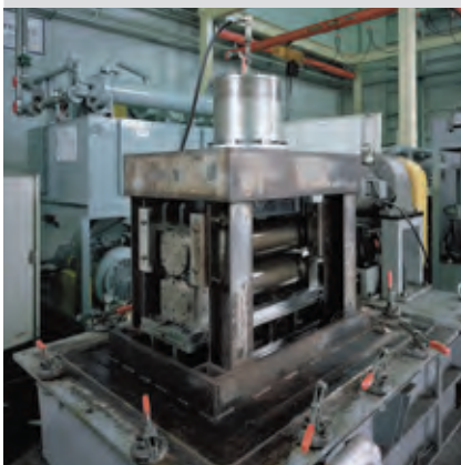
Prüfstand für die Wälzlager einer Strangführungsrolle
