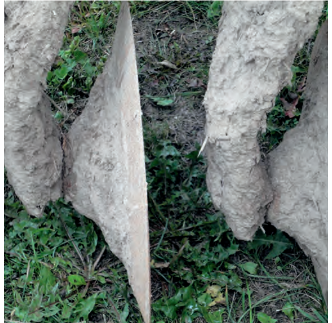
Typisches Bild einer Kurzscheibenegge mit starken Verschmutzungen nach Einsatz mit Gülle.
