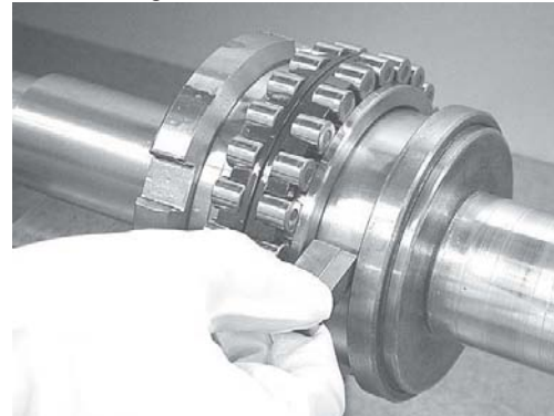
Abb. 1.15: Messen der erforderlichen Zwischenringbreite
