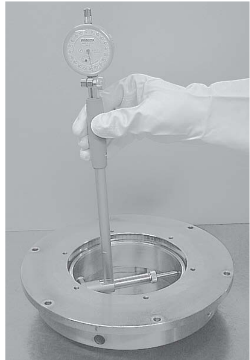
Abb.1.11: Laufbahndurchmesser des Außenrings auf das GN-Hüllkreismessgerät übertragen
