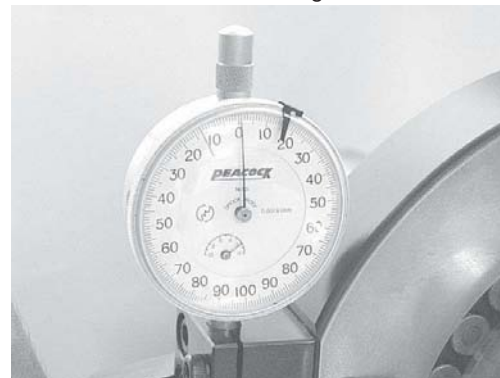
Abb. 1.15: Messen der erforderlichen Zwischenringbreite
