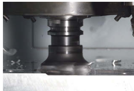
Stirnfräser: Ø80 Werkstoff: S50C Drehzahl: 1 200 min -1 504 cm 3 /min
