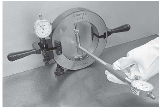
Abb.1.11: Laufbahndurchmesser des Außenrings auf das GN-Hüllkreismessgerät übertragen
