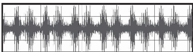
Frequenzkurve eines Wälzlagers mit Schäden auf der Laufbahn
