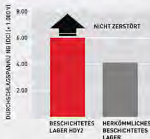
ABB. 3 – MECHANISCHE FESTIGKEIT: ERGEBNISSE SCHLAGPROBE KERAMIKBESCHICHTUNG (6311, AUSSENRING)
