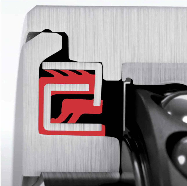
Dichtungskonzept Agri Hub
