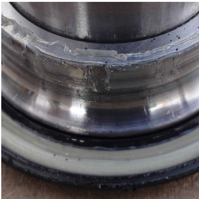
Die Kugellaufbahnen zeigen keinerlei Beschädigungen oder Verschleiß.
