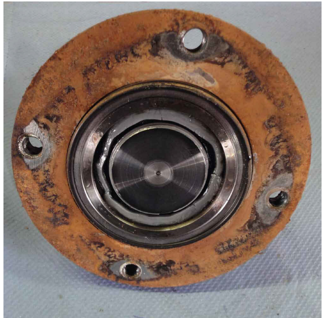
Das Bild zeigt, dass weder Verschmutzungen noch Rost im relevanten Bereich innerhalb des O-Rings zu finden sind.
