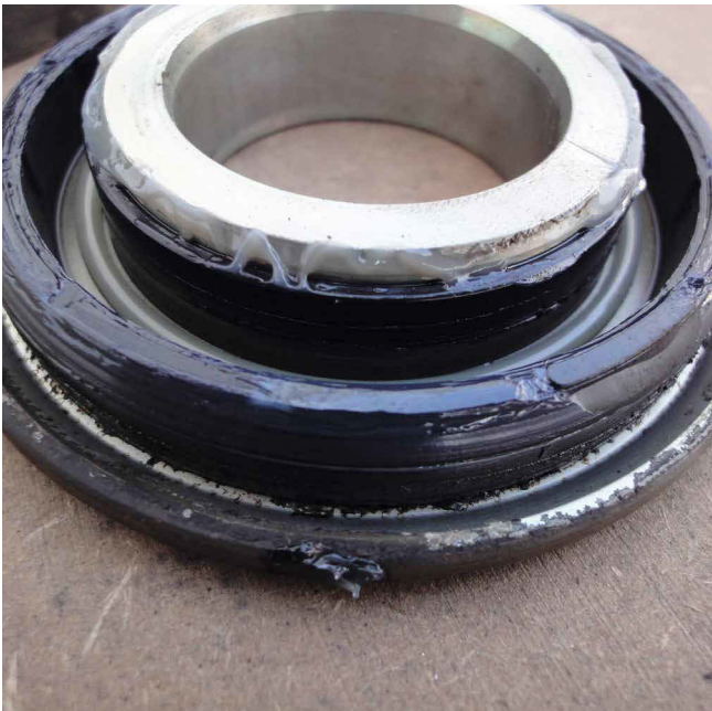
Es konnte kein Schmutz durch die Kassettendichtung eindringen. Die Dichtung ist in einem hervorragenden Zustand.
